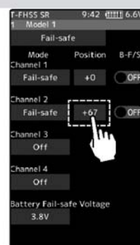
Inställning av "Fail Safe" läge Håll manöverdonet för aktuell kanal i önskat läge och tryck på "Position" knappen.
