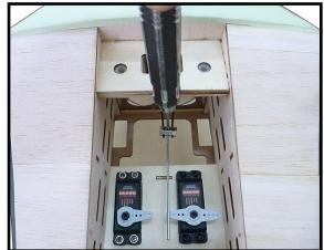
RUDDER PUSHROD INSTALLATION
