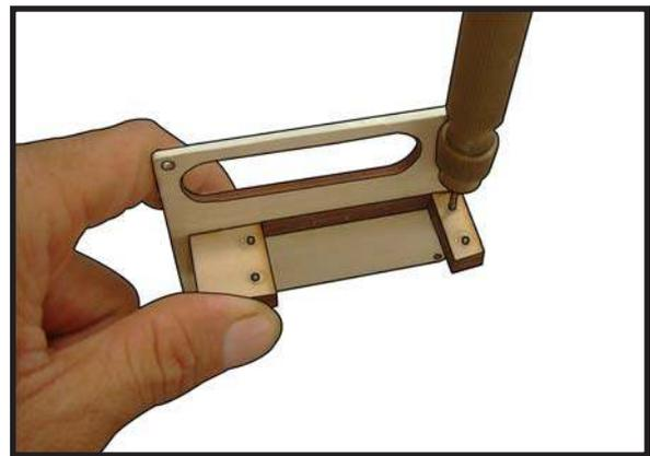
**INSTALLING THE AILERON - FLAP SERVOS.**
