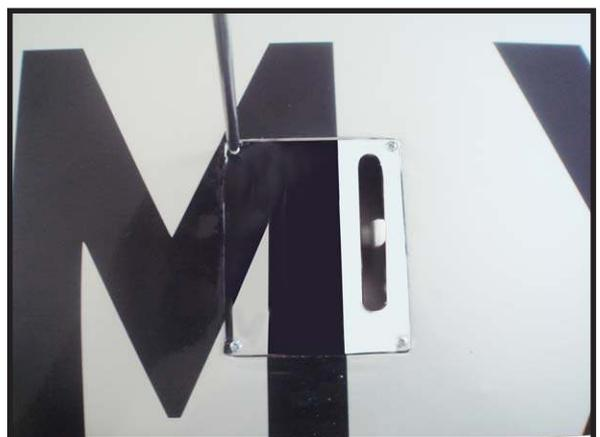
**AILERON PUSHROD HORN INSTALLATION.**
