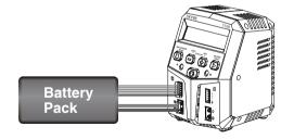
TO AVOID SHORT CIRCUITS, ALWAYS CONNECT THE CHARGE LEADS TO THE CHARGER FIRST, AND THEN TO THE BATTERY. REVERSE THE SEQUENCE WHEN DISCONNECTING THE PACK.
