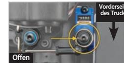
**Differenzial geschlossen:** Schalten Sie den Sender und den Empfänger ein. Bringen Sie den T-Lock Schalter in die mittlere Position um das vordere Differenzial zu schließen. Bestätigen Sie, dass sich die Ausgangswelle des Servos gegen den Uhrzeigersinn dreht, um das Servohorn in die gezeigte Position drehen: mit dem Schlitz der Feder senkrecht zur Verbindung und so, dass der Umlenkhebel zum Servo gedrückt wird.
