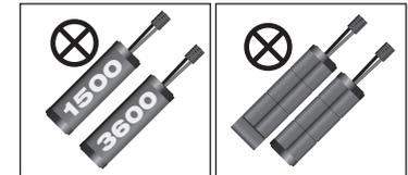
Verwenden Sie keine Batterien mit unterschiedlichen Kapazitäten. Benutzen Sie zwei Batterien mit der gleichen Kapazität.
