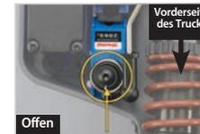
**Differenzial geschlossen:** Schalten Sie den Sender und den Empfänger ein. Bringen Sie den T-Lock Schalter in die untere Position um das hintere Differenzial zu schließen. Bestätigen Sie, dass sich die Ausgangswelle des Servos gegen den Uhrzeigersinn dreht, um das Servohorn in die gezeigte Position drehen: mit dem Schlitz der Feder senkrecht zur Verbindung und so, dass der Umlenkhebel vom Servo weggedrückt wird.
