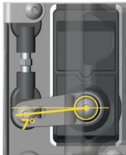
Falls nötig, stellen Sie die Länge der zweiten Lenkungsverbindung fein ein, um jegliche Last auf das Lenk-System in der neutralen Position zu entfernen. Wenn Sie Ersatz-Servos verwenden, ist es wichtig, dass die Servohörner für den Summit entwickelt wurden. Zusätzliche Servohörner werden separat für den Gebrauch mit nicht-Traxxas Servos verkauft.
