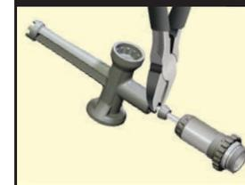
C. Entfernen/Montieren des Stabendes
