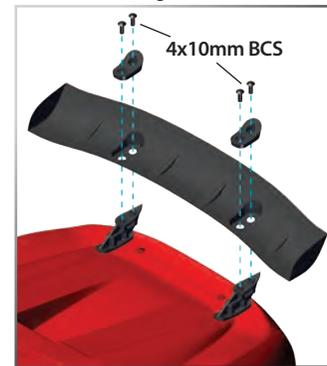
Montage des Kotflügels für 160 km/h (100 mph)
