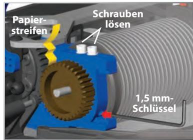
Tipp: Für die Einstellung des Zahnadeingriffs kann ein Stück Notizpapier als Hilfe zwischen das Ritzel und das Zahnrad geschoben werden. Schieben Sie das Stück Papier zwischen das Ritzel und das Zahnrad, bevor sie die Schrauben der Motorhalterung festziehen. Stellen Sie das Ritzel so ein, dass es komplett in das Zahnrad eingreift und ziehen Sie dann die Motorhalteschrauben an. Entfernen Sie das Papier, falls Sie es benutzt haben. Sie sollten jetzt den erforderlichen, minimalen Spalt Platz haben.
