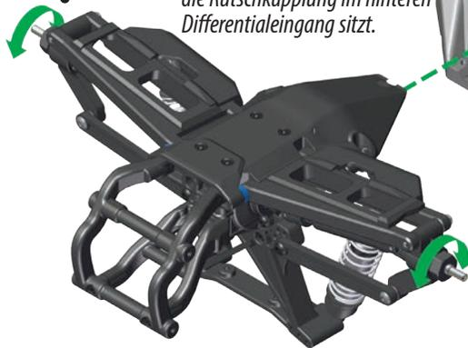
**Hinweis:** Vergewissern Sie sich, dass die hintere Trennwand richtig, wie gezeigt, an das Chassis angepasst ist, bevor Sie die Schrauben festziehen.
