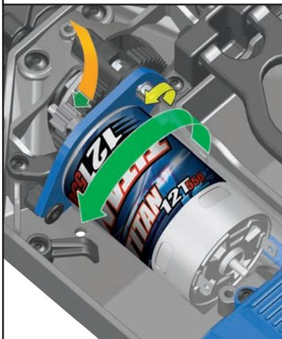
Schieben Sie den Motor nach vorne, damit das Ritzel in das Zahnrad eingreift. Ziehen Sie die Schrauben des Motors wieder fest und entfernen Sie den Streifen Papier.
