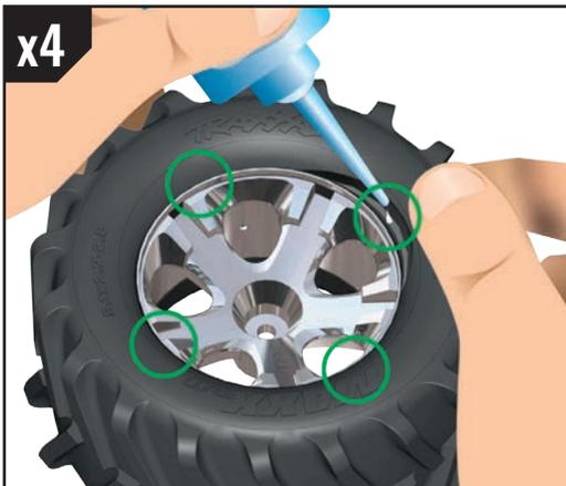
*Kleben Sie die Reifen auf die Räder. Drücken Sie mit Ihrem Daumen die Seite des Reifens von der Felge weg. Wiederholen Sie dies an vier Punkten am Umfang des Rads. Drehen Sie das Rad um und wiederholen Sie die obigen Schritte an der Innenseite des Rads.*
