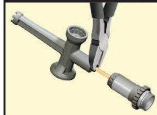
C. Entfernen/Montieren des Stabendes
