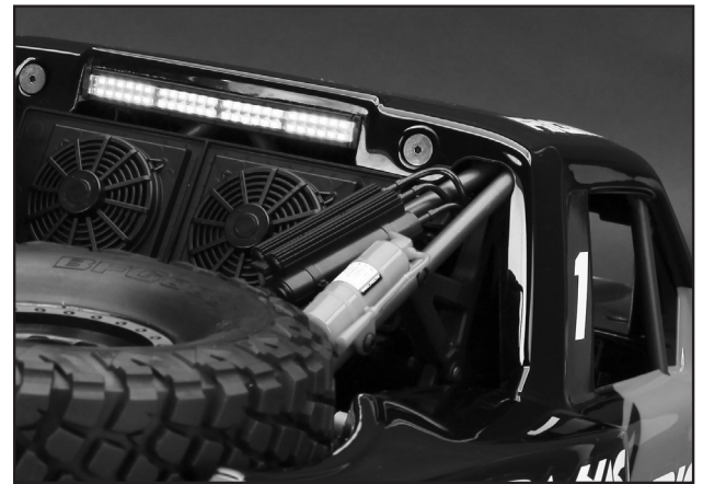
Installierte Hintere LED-Lichtleiste
