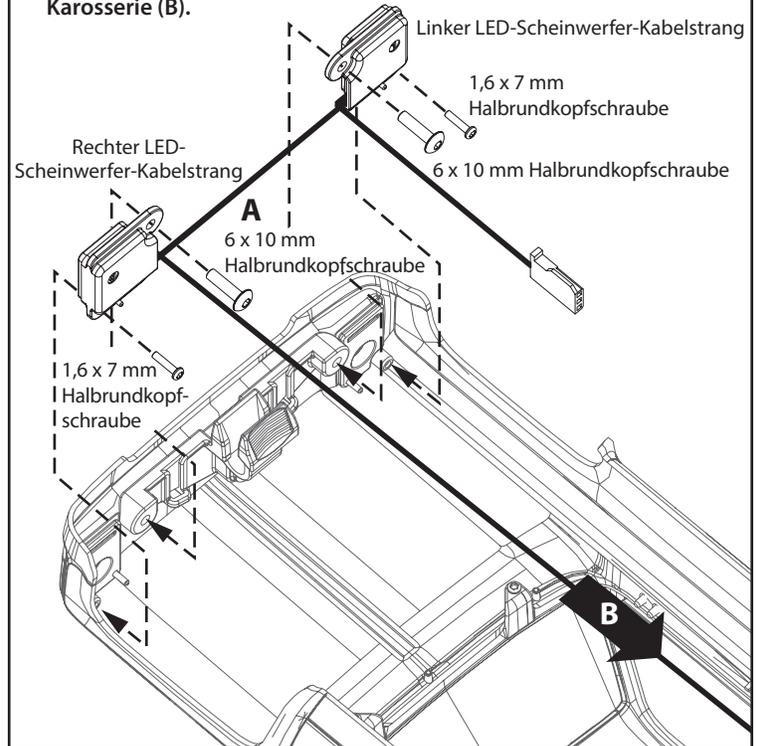
3. Montieren Sie den rechten und dann den linken LED-Rücklicht-Kabelstrang.
