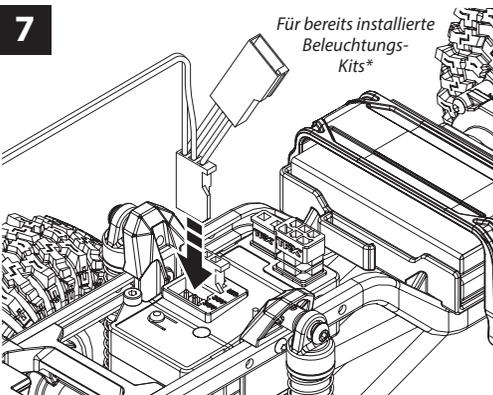
Stecken Sie den Y-Kabelbaum in einen offenen ACC-Anschluss am elektronischen Steuermodul (ECM). Die LED-Leuchten leuchten auf, wenn das ECM durch Einstecken der Batterie eingeschaltet wird.
