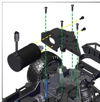
Um den Zahneingriff einzustellen, identifizieren Sie anhand der rechten Tabelle die Schraubenpositionen an der Getriebeabdeckung (D - H), die der gewählten Größe des Motorritzels (18T - 22T) und der Zahnradgröße (47T) entsprechen. Lösen Sie die beiden Schrauben vom Motor/der Getriebeabdeckung und setzen Sie sie an den entsprechenden Positionen wieder ein; setzen Sie die Motor-/Getriebeabdeckung wieder in das Chassis ein.
