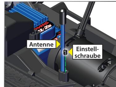
**!** Vor der Benutzung Ihres Modells, müssen Sie sicherstellen, dass die Antenne richtig installiert ist. Siehe "Installieren der Empfängerantenne." Ein Fehler bei der richtigen Installation der Empfängerantenne kann einen deutlich kleineren Funkbereich und die Möglichkeit eines Kontrollverlusts zur Folge haben.
