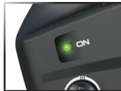
Wenn die Status-LED rot blinkt, sind eventuell die Batterien des Senders schwach, entladen oder nicht richtig installiert. Ersetzen Sie sie mit neuen oder frisch geladenen Batterien. Die Anzeigelampe zeigt nicht den Ladezustand der im Modell installierten Batterie an. Mehr Informationen über Sender, Statusanzeige und LED-Signale finden Sie auf Seite 18 im Abschnitt Fehlerbehebung.
