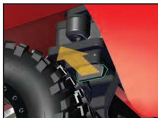
Extracción del carrocería sin clips
