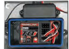
**Hinweis: Für beste Performance empfehlen wir, diesen Empfänger mit derselben Ausrichtung zu installieren, mit der auch der Original-Empfänger installiert war wie gezeigt.**
