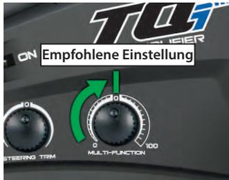
Drehen Sie den Schalter im Uhrzeigersinn, um die Hilfeleistung zu erhöhen, oder gegen den Uhrzeigersinn, um die Hilfeleistung zu verringern. Drehen Sie den Multifunktionsschalter bis zum Endpunkt gegen den Uhrzeigersinn, um TSM vollständig auszuschalten.
