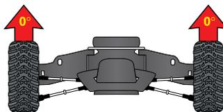
6. Wenn Sie von oben auf Ihr Modell sehen, sollten die Vorderräder geradeaus nach vorne zeigen. Wenn die Räder leicht gedreht sind, schalten Sie den TSM aus (siehe Seite 17). Drehen Sie am Trim-Schalter am Sender, bis sie exakt geradeaus stehen. Setzen Sie das Multifunktionsschalter auf die gewünschte Einstellung des TSM.
