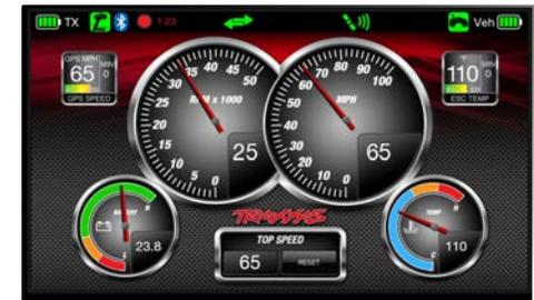
Das anpassbare Traxxas-Link-Armaturenbrett zeigt Daten für Drehzahl, Geschwindigkeit, Temperatur und Spannung in Echtzeit an.
