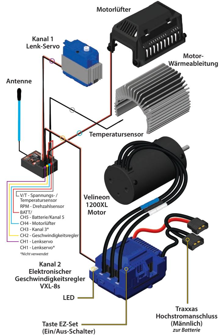
\*\* Zusätzlicher Sensoranschluss zur Verwendung mit der Telemetrie-Erweiterungsmodul (mehr Informationen auf Traxxas.com und in den mitgelieferten Materialien)
