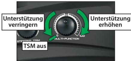
Drehen Sie den Multifunktionsschalter bis zum Endpunkt gegen den Uhrzeigersinn, um TSM vollständig auszuschalten.
