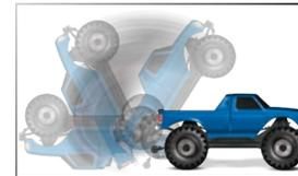
**Hinweis:** Bestimmte Fahroberflächen oder Bedingungen können das Modell eventuell bei der Selbstaufrichtung behindern. Nach mehreren Versuchen wird das Selbstaufrichten abgebrochen. Drücken Sie die SET-Taste, um es erneut zu versuchen oder holen Sie Ihr Modell zurück.
