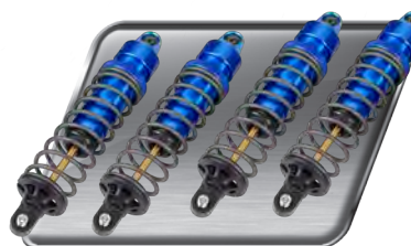
GTX Aluminium-Stoßdämpfer mit TiN Wellen
